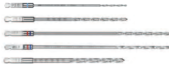
Punta innesto rapido \varnothing 2.0, L 110, spirale 25 IU 7420-10 Punta innesto rapido \varnothing 2.5, L 110, spirale 50 IU 7425-00 Punta innesto rapido \varnothing 2.7, L 150, spirale 50 IU 7427-15 Punta innesto rapido \varnothing 2.7, L 150, spirale 50, graduata IU 7427-16 Punta innesto rapido \varnothing 3.5, L 110, spirale 50 IU 7435-00
